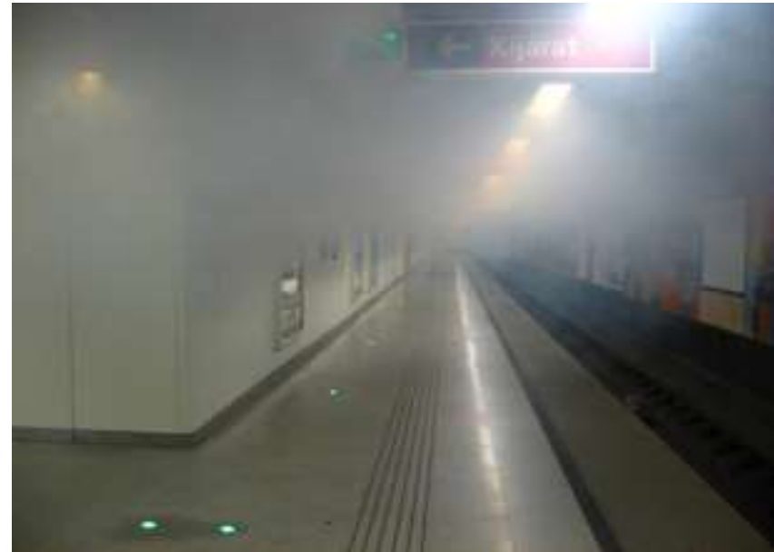
Kép: a budapesti Metró füstelárasztásos vizsgálata
