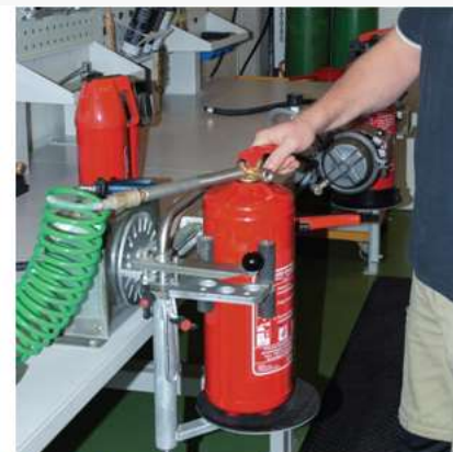
A készüléket nitrogénnel nyomás alá helyezzük
