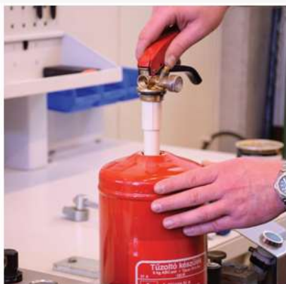
Komplett fejszerelvény függőleges behelyezése a tartályba
