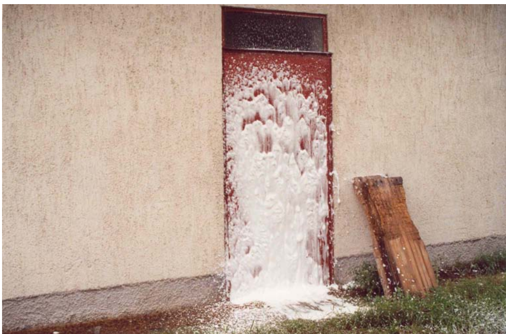
8. sz. melléklet: a Vízköddel oltóval fejlesztett nehézhab 10 perc után is kiválóan megtapad a függőleges felületen.
