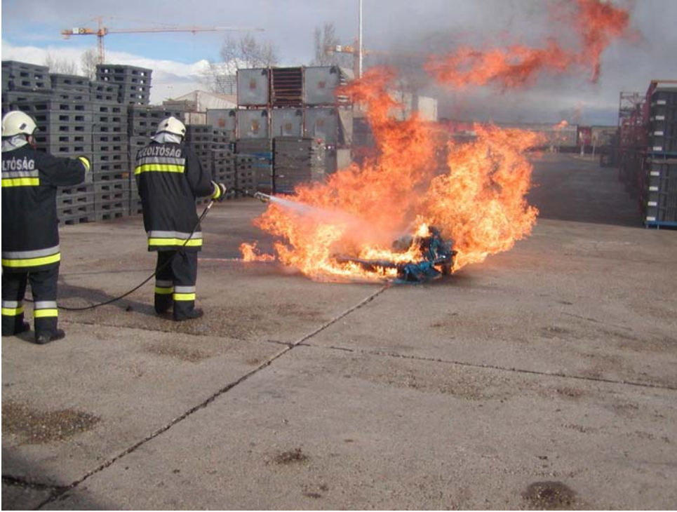
5. sz. melléklet: Oltás vízköddel oltóval, vízzel.
