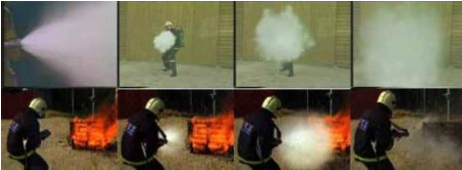
1. sz. kép: Az impulzusoltó működése
