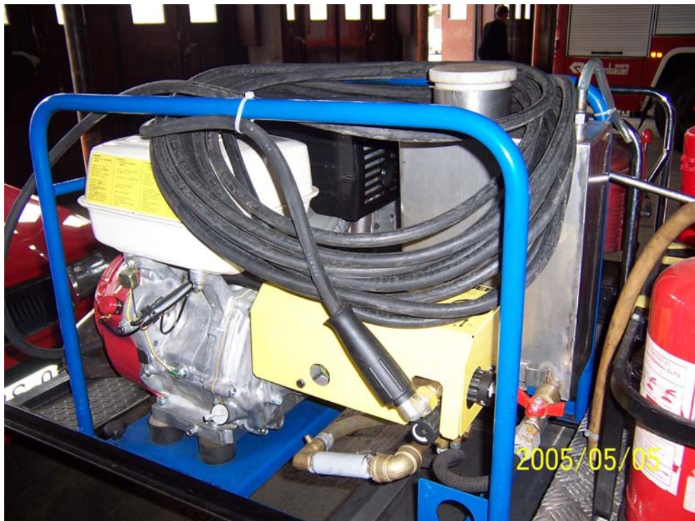
2. sz. melléklet: Az UNIJET FOG típusú vízköddel oltó berendezés.
