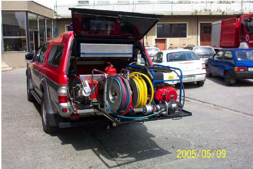
1. sz. melléklet: A győri tűzoltóság Mitsubishi Pajero típusú gyorsbeavatkozó gépjárművében, közös konzolon elhelyezett vízköddel oltó, és fészítő-vágó berendezések.
