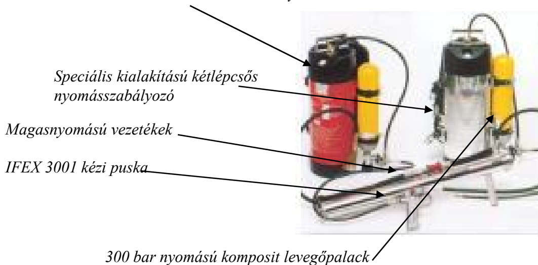
2. sz. ábra. Az IFEX típusú impulzuspuska főbb részei
