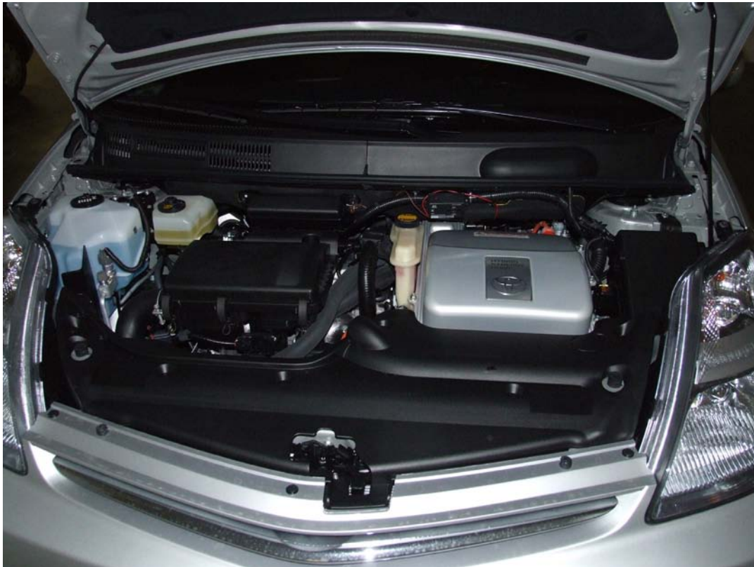
Toyota Prius: Benzinmotor, teljesítményszabályozó (inverter), alatta elektromos motor és generátor, jobbra biztosítékdoboz
