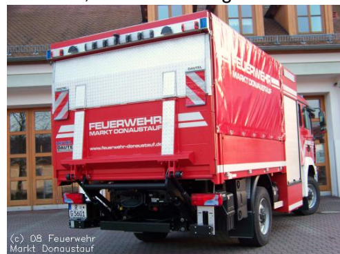
(c) 08 Feuerwehr Markt Donaustauf GW-L2 MAN TGM 13.280 jármű Dautel egyrészes emelőhátfala. Forrás: www.feuerwehr-donaustauf.de
