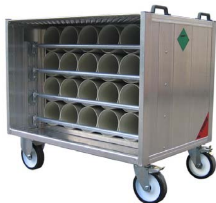
Légzőpalack szállító konténer, 24 db 6,8 literes 300 báros kompozit légzőpalackhoz Forrás: www.gfd-katalog.de
