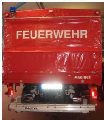
GW-L2 jármű Dautel kétrészes összecsukható emelőhátfala. Forrás: www.feuerwehr-eisleben.de
