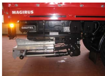
GW-L2 jármű Dautel kétrészes összecsukható emelőhátfala. Forrás: www.feuerwehr-eisleben.de
