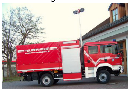
MAN TGM 13.280 GW-L2 (Donaustauf) Kibocsátott fényárbóccal. Forrás: www.feuerwehr-donaustauf.de
