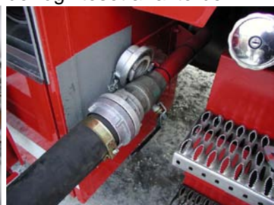
VLKV MAN (2002) FFW Agatharied járművön elhelyezhető IBC tartályok az oltóanyag szállítására, a tartályok csatlakoztatására szolgáló vezetékek és a kismotorfecskendő csatlakozás. Forrás: www.agatharied.de
