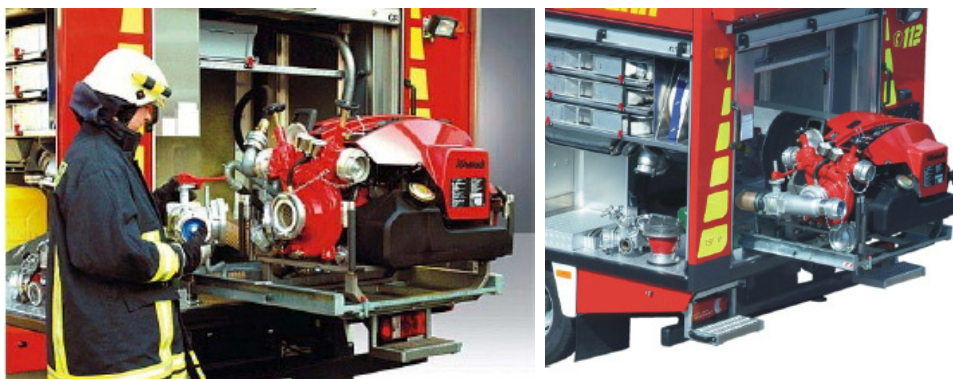
Kismotorfecskendő és tartály csatlakozása TSF-W járműveknél (Schlingmann GmbH). Forrás: www.schlingmann112.de
