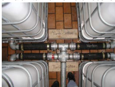
VLKV MAN (2002) FFW Agatharied járművön elhelyezhető IBC tartályok az oltóanyag szállítására, a tartályok csatlakoztatására szolgáló vezetékek és a kismotorfecskendő csatlakozás. Forrás: www.agatharied.de
