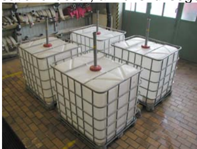
VLKV MAN (2002) FFW Agatharied járművön elhelyezhető IBC tartályok az oltóanyag szállítására, a tartályok csatlakoztatására szolgáló vezetékek és a kismotorfecskendő csatlakozás. Forrás: www.agatharied.de
