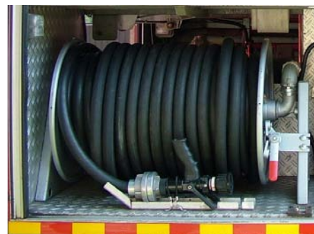
50 m.-es normál nyomású gyorsbeavatkozó tömlő, Leader Quadrafog 150 típusú sugárcsővel (MB 1019 TLF 16/25, Gyomaendrőd ÖT) Forrás: saját fotó
