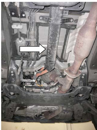
12. ábra Alváz alatt futó H kábel
