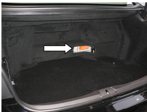
7. ábra Limuzinok megszakítója a csomagterben
