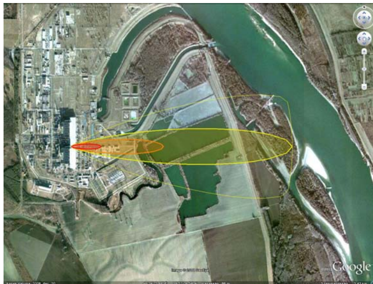
8. ábra. Az ALOHA grafikus kimenete a Google Earth térképére vetítve. Egy feltételezett paksi atomerőművi kibocsátás hatásának modellezése.
