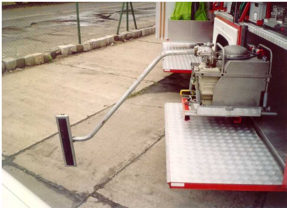
Univerzális szivattyú, talajról folyadékot felszívó szűrőfej
