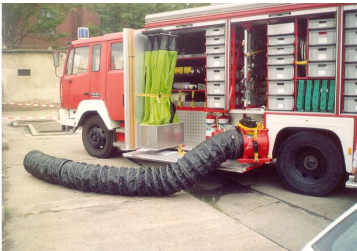
Elfűvőventilátor (10000 m 3 /óra) légszállítási teljesítménnyel
