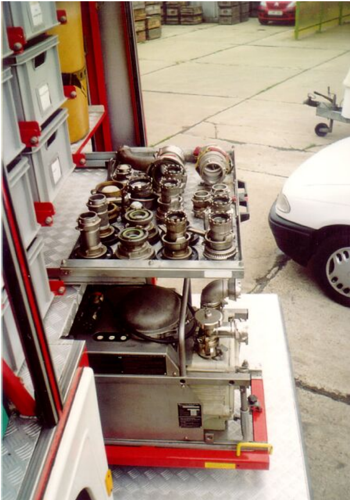
Univerzális csatlakozók a legkülönbözőbb csatlakozási átmenetekhez
