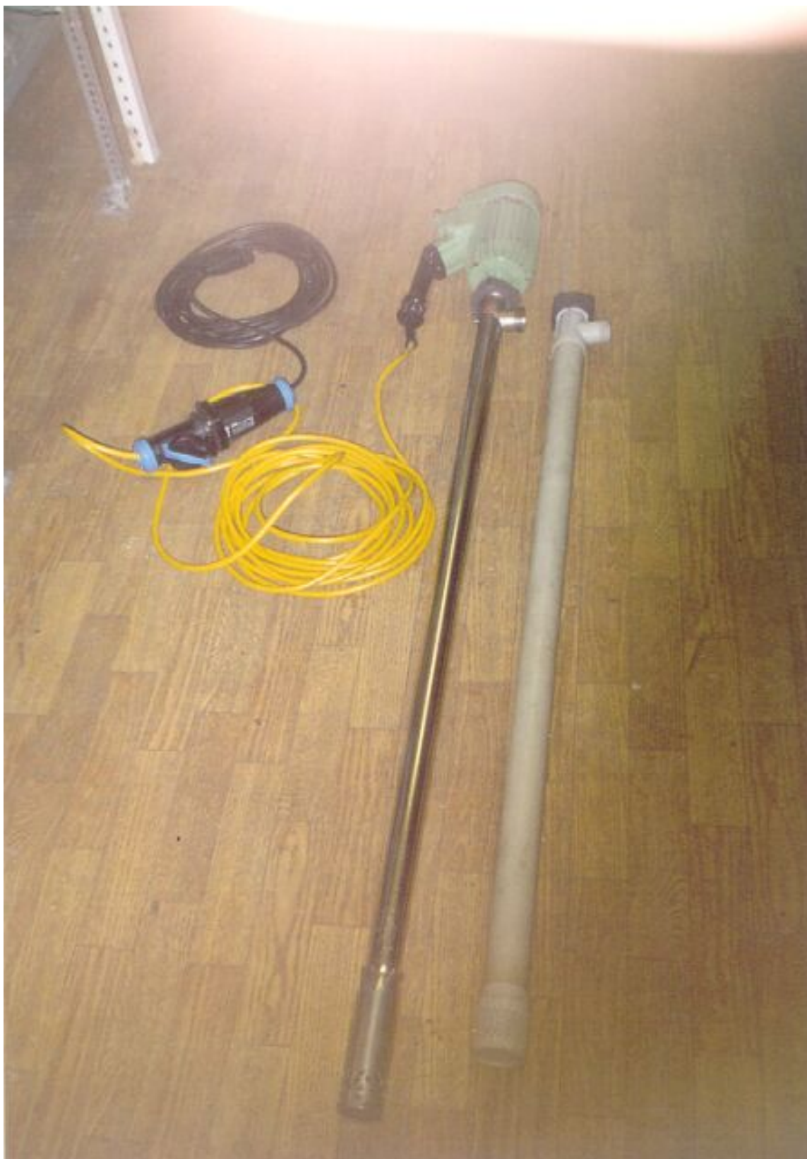
Hordópumpák, K1-es acélból, ill. műanyagból a különböző agresszivitású anyagok hordókból való kiszivattyúzására
