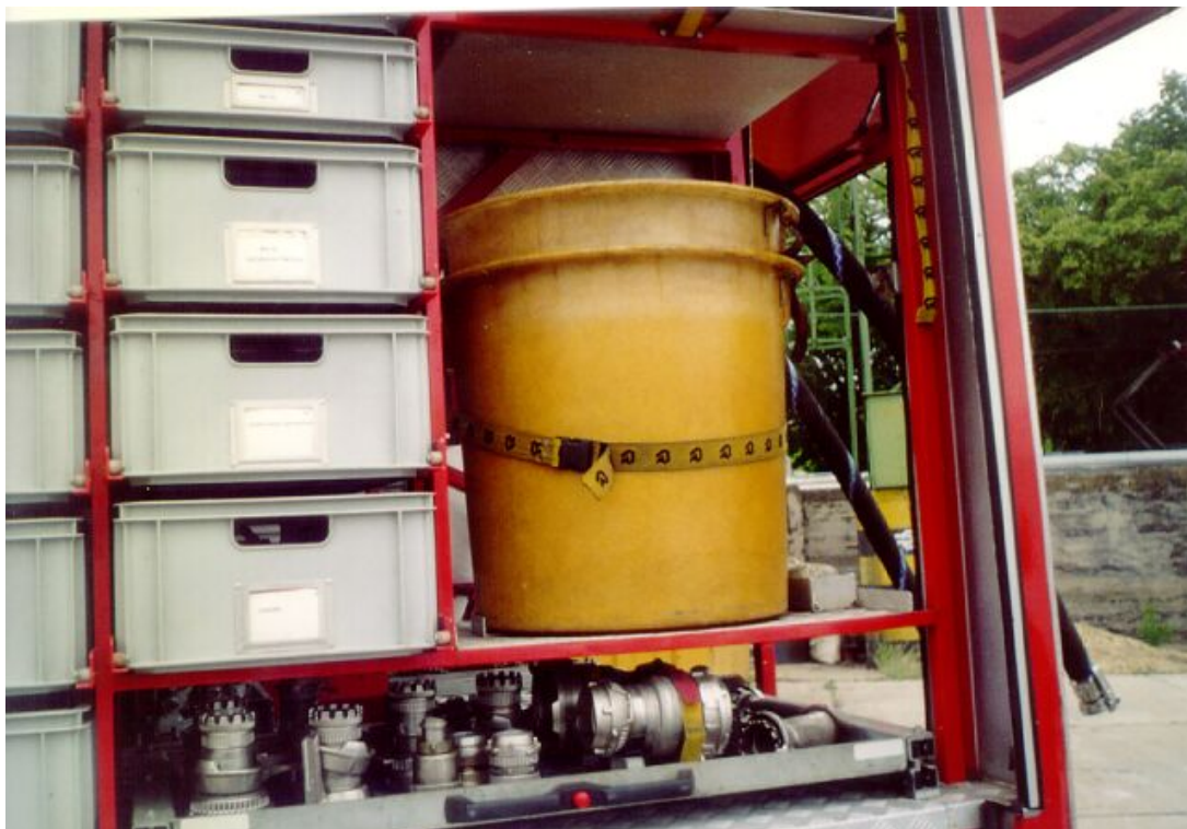
Kármentő edényzet savak, lúgok, kevésbé agresszív oldószerekhez
