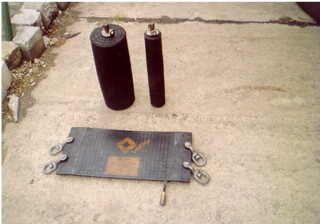
Különböző Vetterpárnák, tartály, ill. csövek sérülésének elzárására
