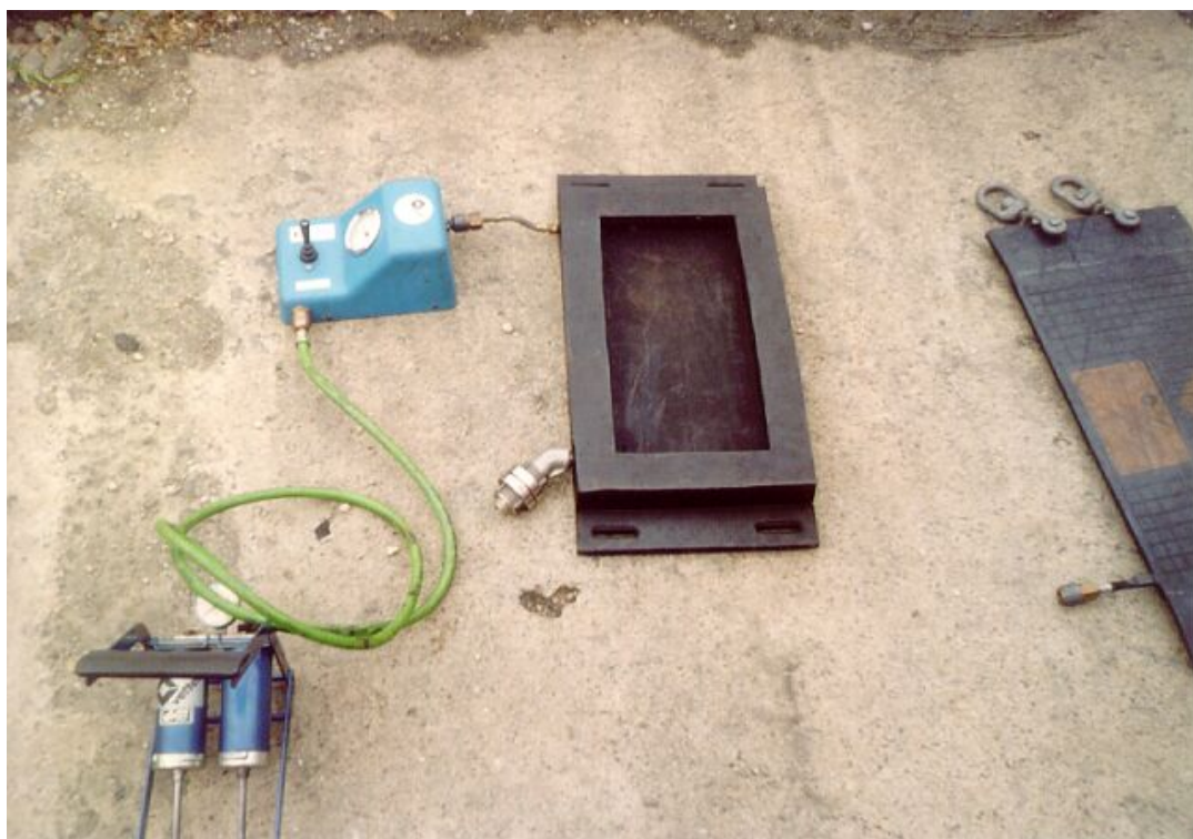
Speciális Vetterpárnák, amelyeket a tartálysérülések helyére feszíthetnek, a baloldali párna folyadékleeresztő szeleppel rendelkezik
