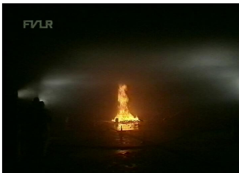
11. ábra Belgium 1998. Genti tűzkísérlet videokép Csarnok épület hő- és füstelvezető berendezés működése nélkül
