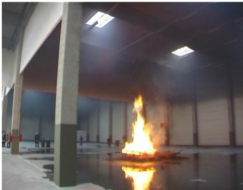
2. ábra Friss levegő utánpótlás nélküli hő- és füstelvezetés 2005. január 17. Tűzkísérlet Dél-Budai Logisztikai Központ
