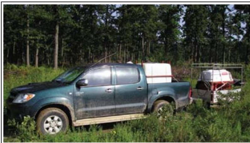
6.1. ábra: Fecskendős tűzoltóvíztartály szállítására alkalmas platós kisteherautó (forrás: MGT-2000 Bt tájékoztatófüzet)
