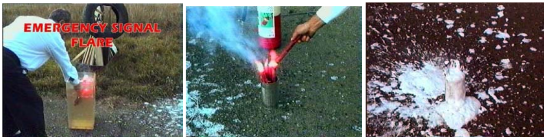
28. ábra Közúti jelzőfáklya köteg tűzénel oltása
