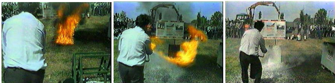
26. ábra Napalm keverék oltása instant habbal
