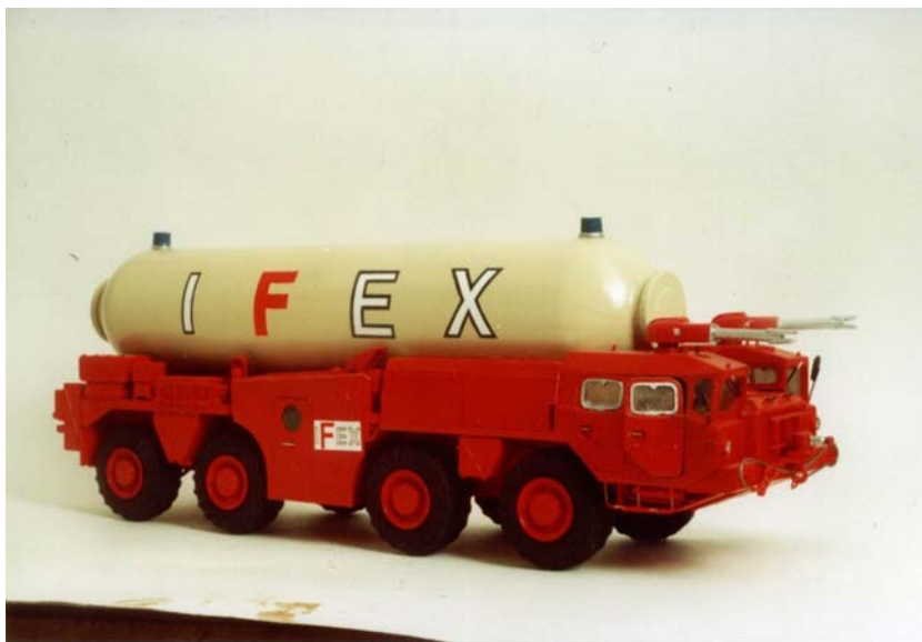
23. ábra A két darab 10 m 3 /perc teljesítményű monitorral szerelt gyorsbeavatkozó modellje
