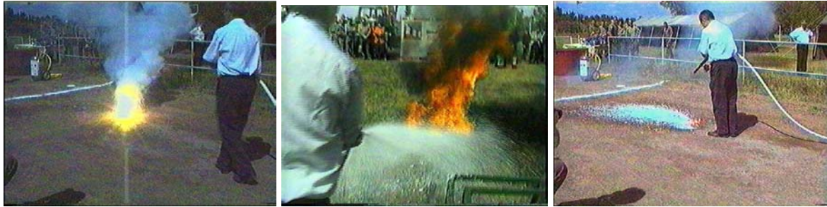
25. ábra Katonai termit préstest oltása instant habbal
