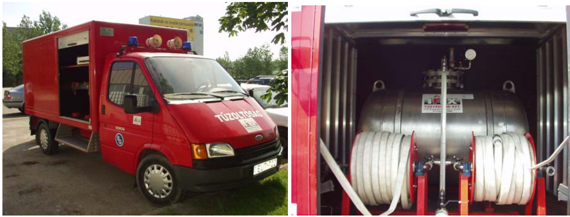
17. ábra Ford Transit alvázra épített felépítmény 500-as habbal (Dorog)
