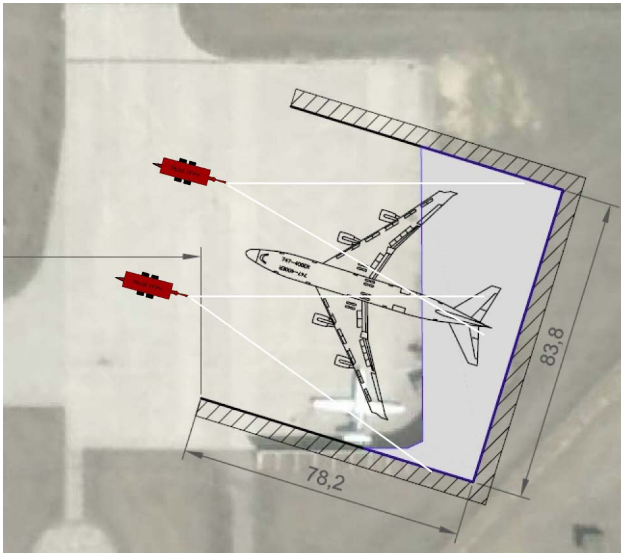
31. ábra A két utánfutóra szerelt instant hab tartály az oszcilláló monitorokkal
