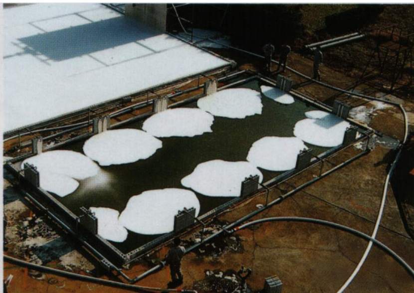
6. kép Habbevezetési kísérlet 12 ponton Fukada Kogyo kutatóközpontjában
