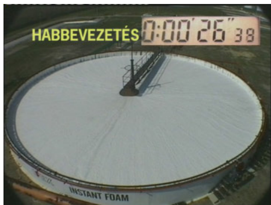
7a, b, c kép Hideg habterületi próba a folyamatos lineáris fúvóka alkalmazásával 500m 2 felületű kísérleti tartálymodellen
