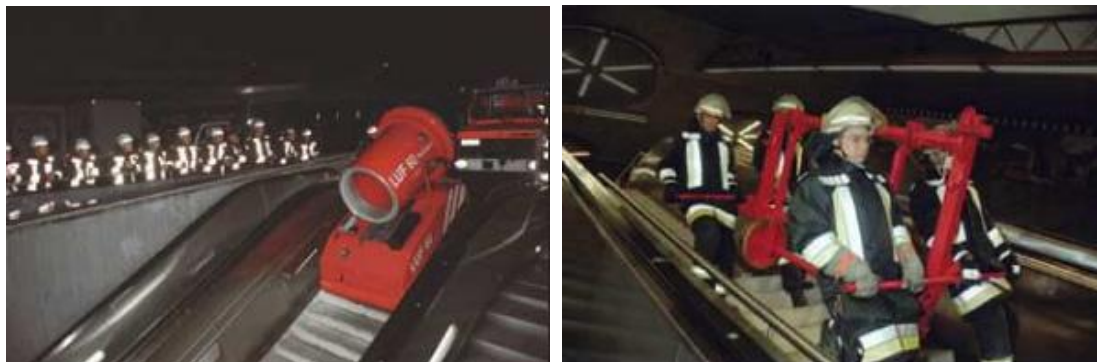
11. és 12. kép: Balra a stuttgarti tűzoltók az állomás lépcsőjén keresztül juttatják le a járművet a peronra, jobbra az összecsuksukott „rail-kit”-et viszik a jármű után (forrás: rechner.com)
