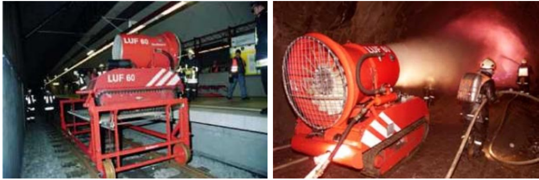
13. és 14. kép: Balra a „rail-kit” használati lehetősége, jobbra a gyártó cég által szervezett tűzoltási bemutató – érdemes megfigyelni, hogy mindegyik tűzoltó oxigénes légzőkészülékben dolgozik (forrás: rechner.com)
