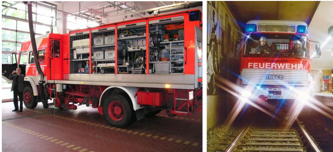
15. és 16. kép: Balra a frankfurti tűzoltóság egyik speciális műszaki mentőszere nyitott málházával, jobbra a metróalagútban közlekedő Iveco Magirus típusú műszaki mentő (forrás: Fővárosi Tűzoltóparancsnokság és Iveco Magirus Brandschutztechnik)
