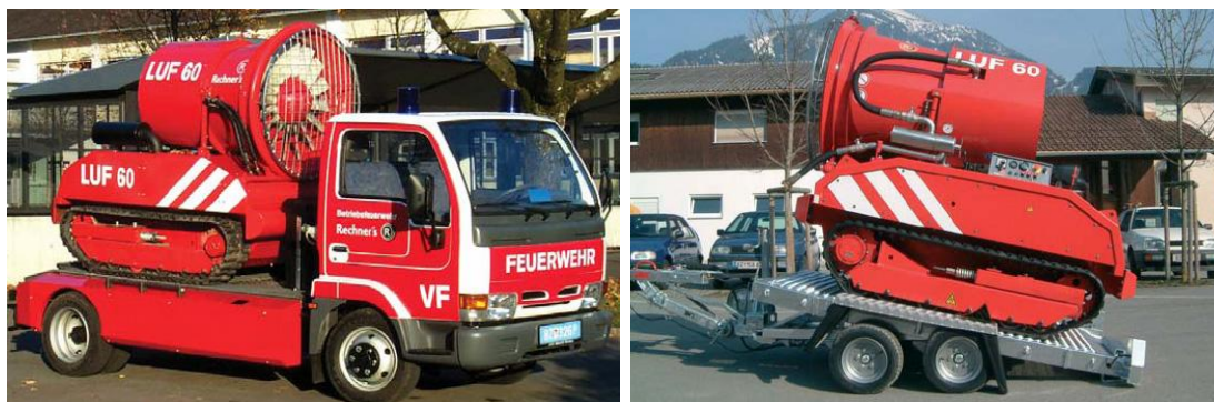
9. és 10. kép: Balra egy kisteherautóból kialakított hordozójármű, jobbra pedig egy hétköznapi utánfutón szállított LUF 60-as (forrás: rechner.com)
