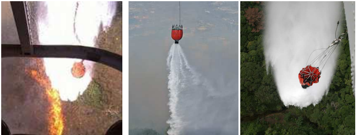
9. kép. Bambi Bucket alkalmazás közben. Forrás: Internet.
