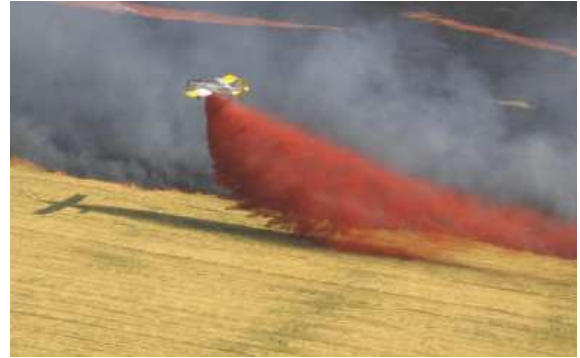
44. ábra. Egyenes vonalban végrehajtott kibocsátási manőver. Ábra forrása: Szerző. Kép forrása: Internet.
