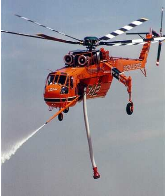
10. kép. Air-Crane S-64 helikopter speciális sugárcsővel. Forrás: Internet.
