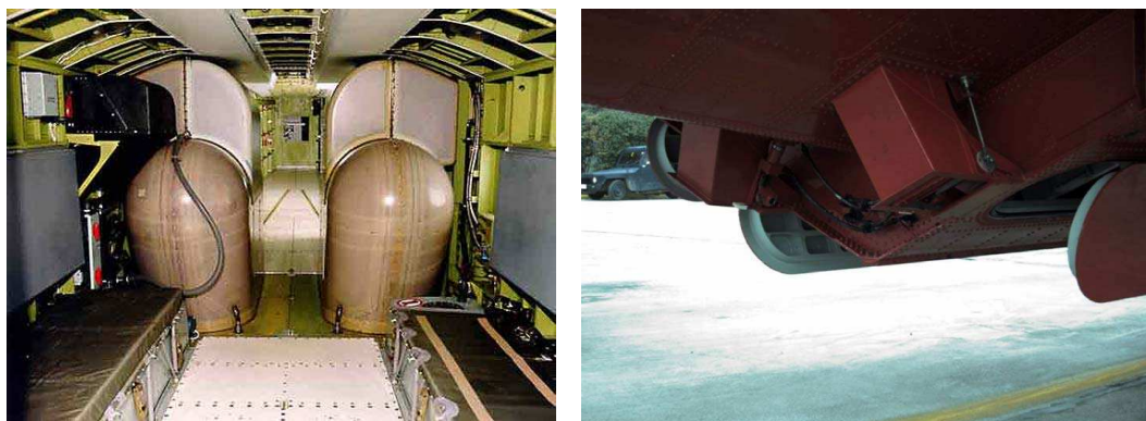
7. kép. CL-415 belső tartálya és kiömlő nyílása: Forrás: Internet.
