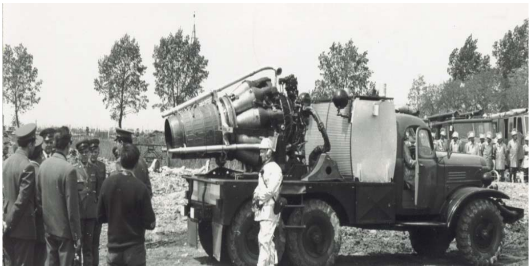
4. kép. Mig-15 szubszónikus sugárhajtóműves repülőgép hajtóművével készült turbóreaktív oltógép
