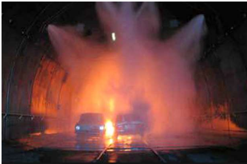
1. sz. kép: Beépített vízköddel oltó rendszer működése alagútban, tűzkísérlet során (forrás: [6])
