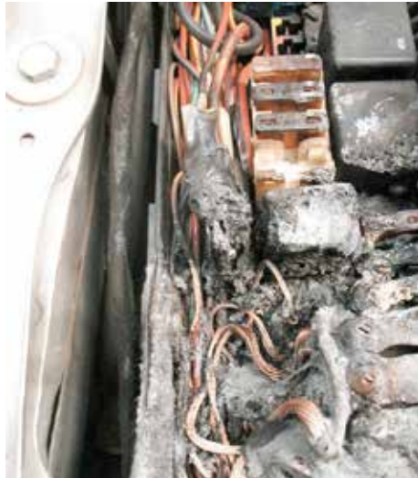
Anyagvesztés a gépkocsi biztosítékdobozán – közepe a tüzet okozó „lengő biztosíték”
