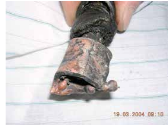
Elektromos áram hatására létrejött olvadásnym egy önindító kábelcsatlakozásán
