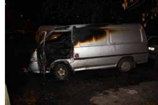
A vezetőülés környezetéből terjedő tűz határoló felületi nyoma a gép karosszériáján
