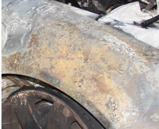
Az acél alacsony hőmérsékletű oxidációjának eredménye
