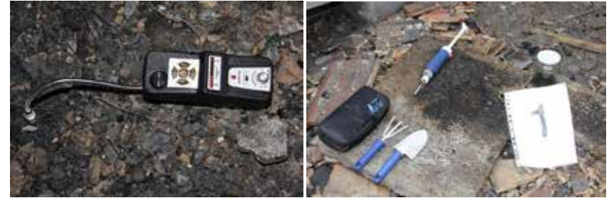
10-11. kép. szénhidrogén érzékelő detektor és indikátorcső gyűjtogatás vizsgálatánál
