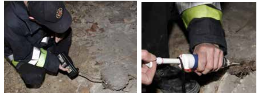
6-7. kép. szénhidrogén érzékelő műszer és indikátorcső használatban a mintavétel helyének meghatározásához
