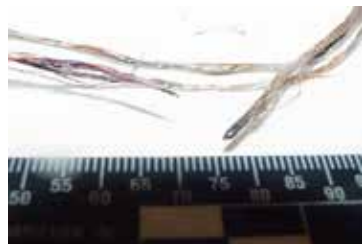
Az elemi szálak összeolvadtak, a vezeték folytonossága megszakadt.
