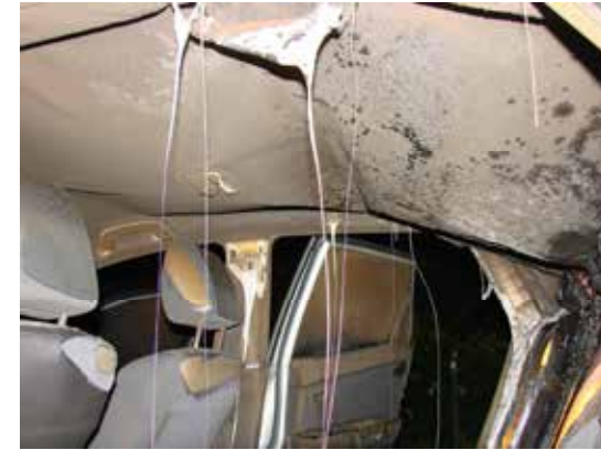
A tető termoplasztikus műanyag alkatrészei az égés során megolvadtak
