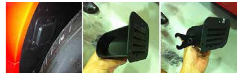
Az első képen az alkatrész helye, a másodikon a régi, a harmadikon az új, módosított elem látható.
