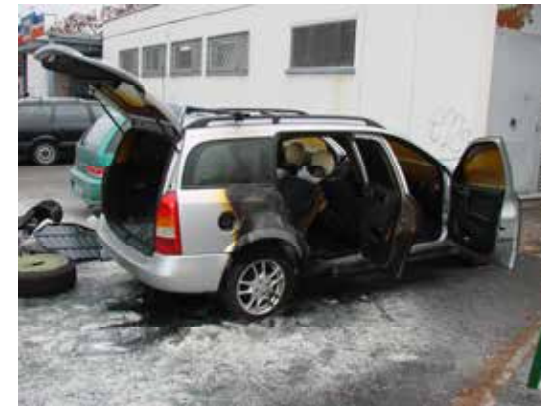
1. ábra: Gépjármű külső részén keletkező tűz terjedése
