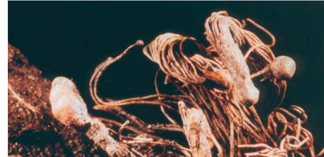
Rézvezetékeken keletkezett göbök (zárlati ömlenyek)
