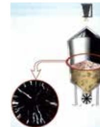
Feltöltődött tömeg felületi kisülése
