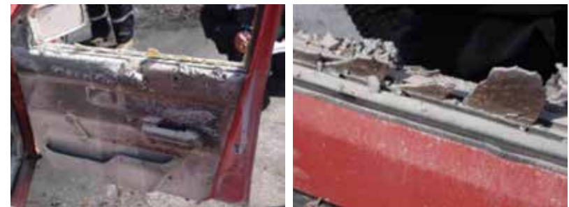
A hő hatására bekövetkező üvegtörés jellegzetes képei
