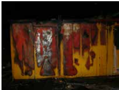
5. kép A konténer bejárati oldalán látható égésnyomok. A kép jobb oldalán a sparhelt füstcső nyílása látható.
