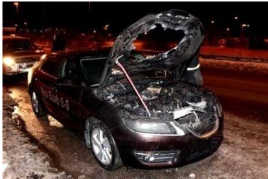
Kör alakú mintázatban kiégett motorháztető
