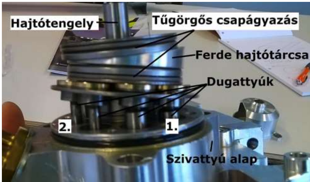
3. ábra Axiális elrendezésű dugattyús szivattyú
