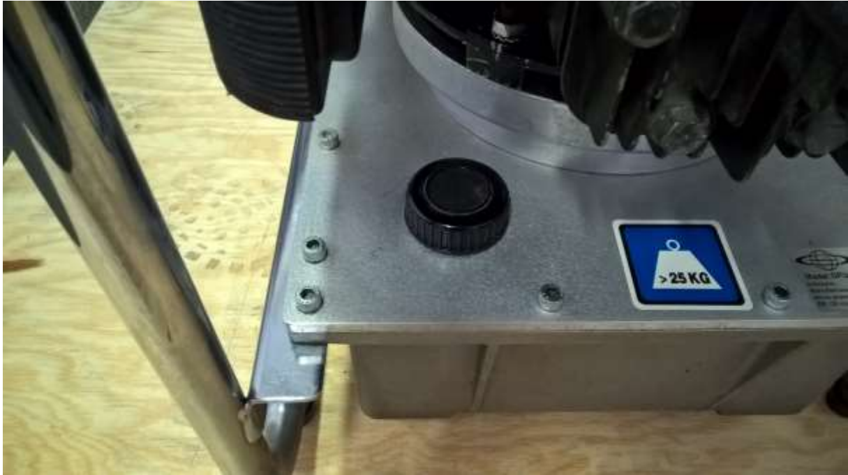
1. ábra Hidraulika olaj nívópálca egy DPU tápegységen
