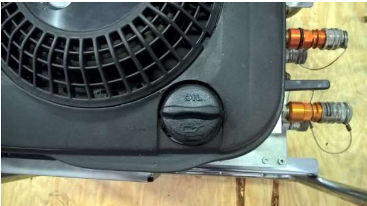
2. ábra Olajnívó helye egy DPU motorján
