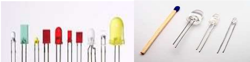
LED-ek különböző tokozásban, színben és méretben
