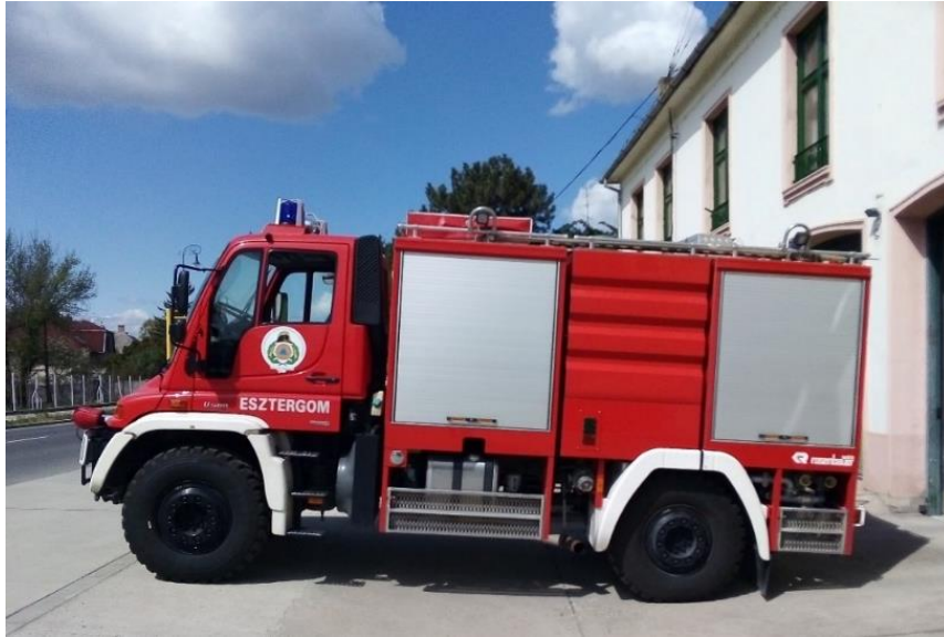
2. ábra Unimog U500 TLF 3000 CAFS. Nagy teljesítmény, de korlátozott terepjáró képesség Készítette: A szerző
