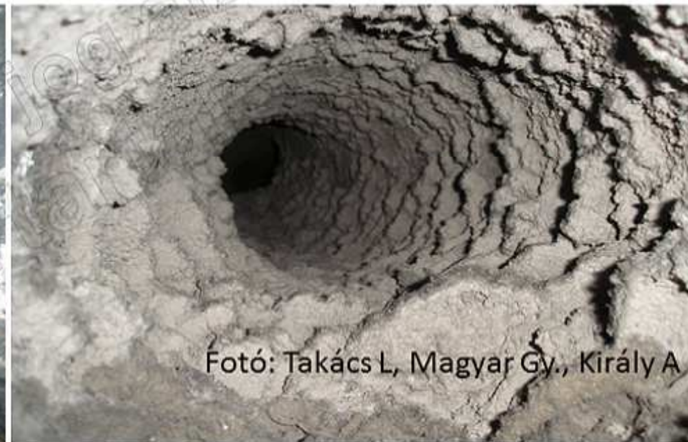
WC füstszivárgás tűz után Szellőzővezeték poros lerakódás
