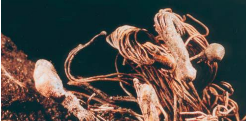
Rézvezetéken keletkezett makroszkopikus göbök (zárlati ömlenyek)
