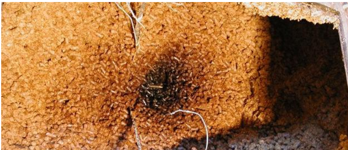
Önmelegedés és pirolízis nyomai biomassza mintában
