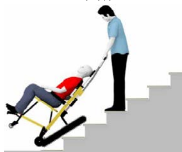
4A ábra: 2Az evakuációs szék használatának elvi bemutatása
