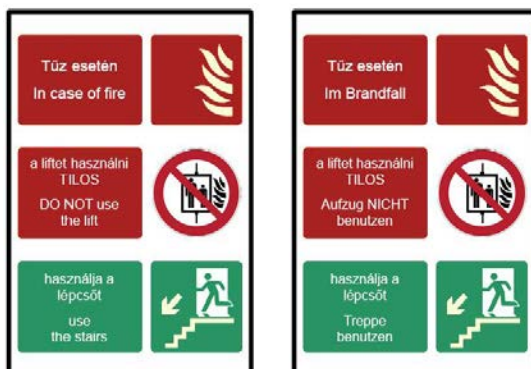
1,215. ábra: Példa tűzhatástól nem védett felvonók tűzeseti használati veszélyére figyelmeztető kétnyelvű táblára
