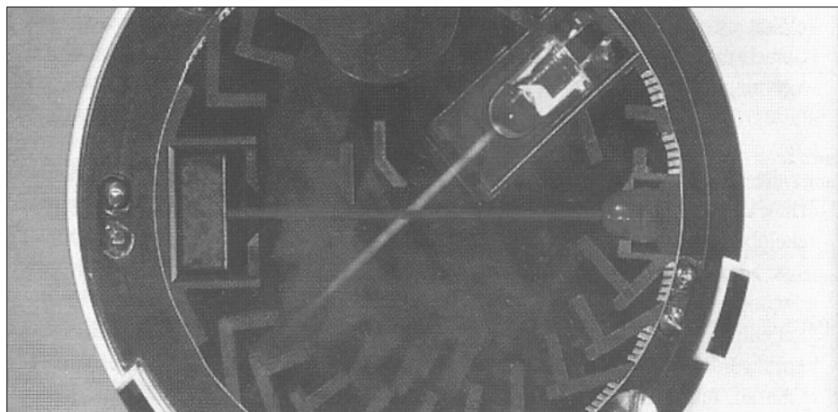
Optikai füstérzékelő belső felépítése
