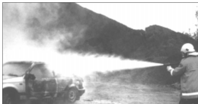
Oltás 65 l vízzel, 2 perc alatt, 100 bar nyomáson
