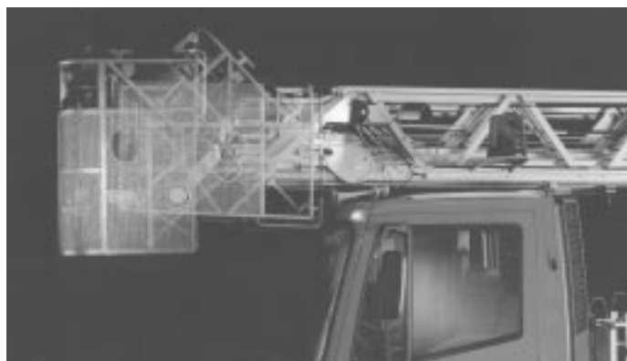
Önműködően készenléti helyzetbe álló mentőkosár
