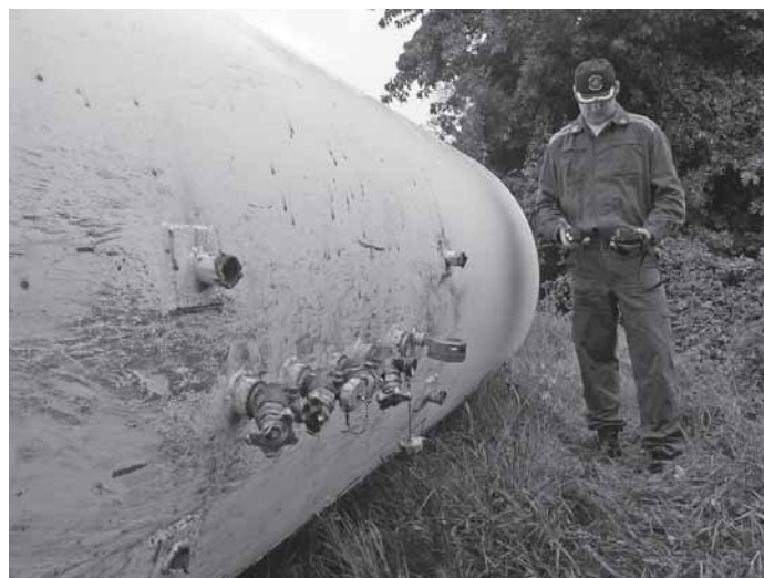
A szelepeket védő csövek letörttek, a szelepek megsérültek, a nyomásmérő ép maradt
