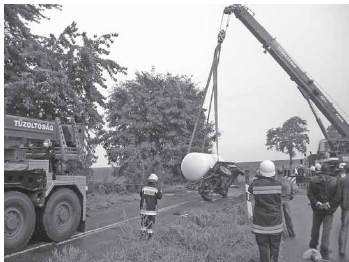
A pótkocsit daruval és csörlővel sikerült felállítani
