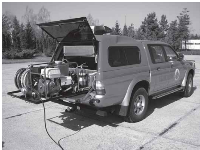
A Mitsubishi L-200 gk.-ra málházott UNIJET-FOG vízköddel oltó berendezés
