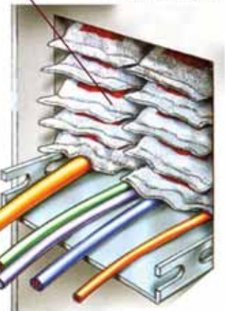
Kábelátvezetés habbal, duzzadó tömítő zsákokkal
