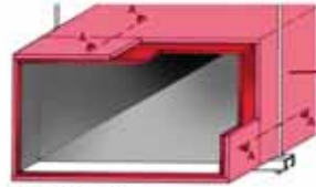
Önálló ill. burkolt légcsatorna T_{IH} = 1,5 óra
