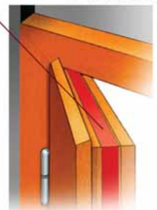
Tűzgátló ajtók tömitése T_{IH} = 0,5-1,5 óra
