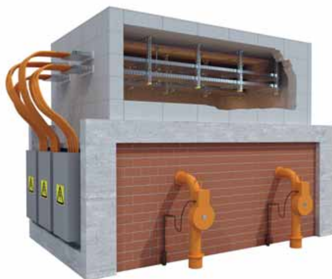
Vizsgáló kamra a DIN 4102-12 vizsgálatának lebonyolításához. A vizsgálat során a kábelt és a tartószerkezeteket együtt vizsgálják.
