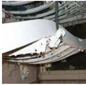
A tűzálló szereléshez használt egyik speciális alkatrész, a konzolok lehaljlás elleni biztosítására szolgáló csatlakozó elem, a vizsgálat előtt és után
