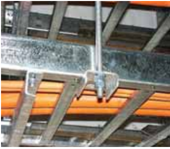
A tűzálló szereléshez használt egyik speciális alkatrész, a konzolok lehaljlás elleni biztosítására szolgáló csatlakozó elem, a vizsgálat előtt és után
