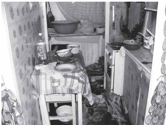
A Fényesudvar 6. sz. alatti lépcsőház földszint 2. lakás konyhája (a tűzkeletkezés helye), a tűzhellyel és a szagelszívó akna éghető burkolatával, amely elsőként gyulladt meg
