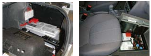
16. ábra. Akkumulátorok sok helyen található
