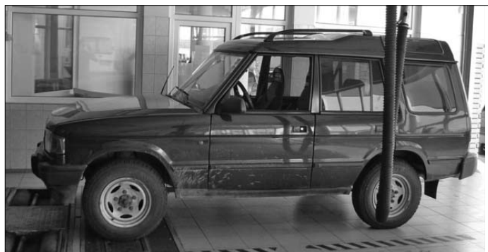
2. ábra. A gépkocsi hosszirányú súlyponti koordinátájának meghatározásához végzett mérés
