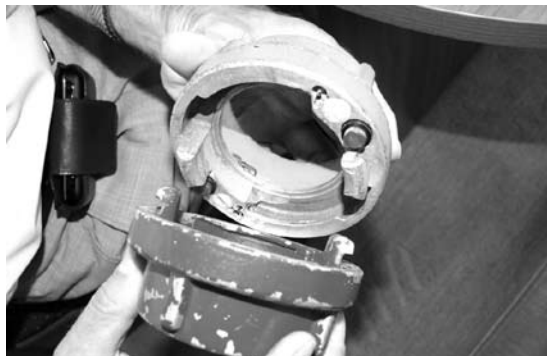
Az átalakított kapcsokba épített ledek adják a fényt
