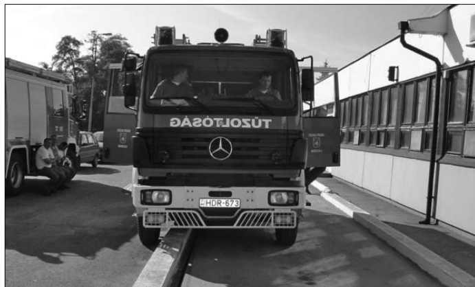
1. ábra A gépkocsi keresztirányú súlyponti koordinátájának meghatározásához végzett mérés
