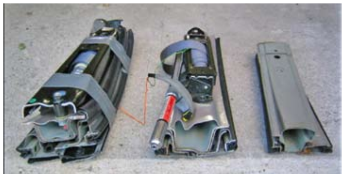
A Volvo B oszlopának lemezprofiljai
