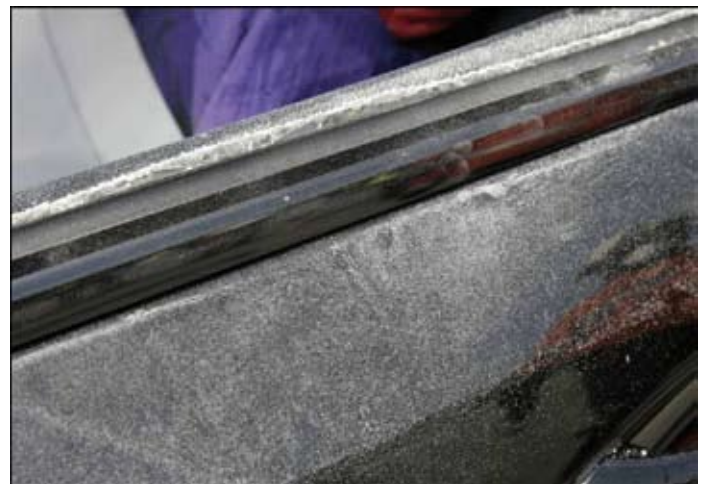
A vágáskor keletkező üvegpors miatt a beavatkozót és a mentendőt is védeni kell
