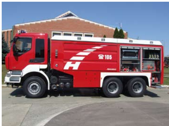
Magasnyomású gyorsbeavatkozó 60 m tömlővel
