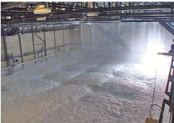
Összefüggő habréteg a stúdióban, a habon láthatók a víz vájta kráterek
