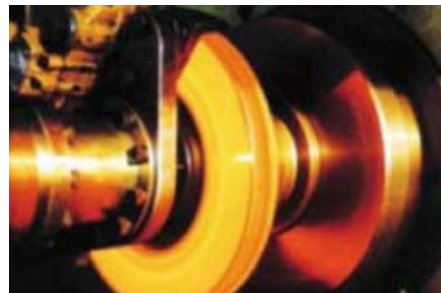
Féktárcsa hőterhelés vizsgálata
