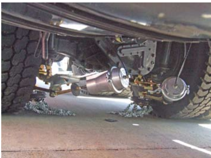
Fülkéből kapcsolható automata hóláncc
