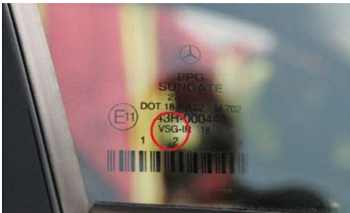
A jelölés (VSG) az üvegen található
