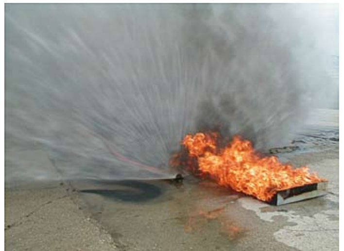
6. kép. A vízfüggöny szívó hatása
