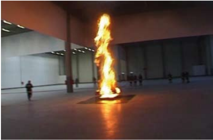
Automatikus nyitás – intenzív láng, jó hő-és füstelvezetés
