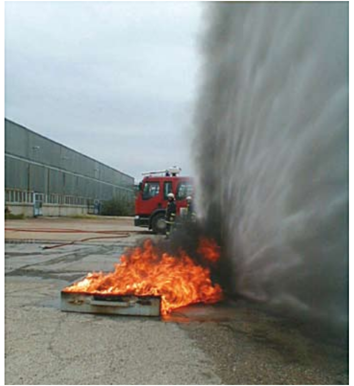
5. kép. A vízfüggöny szívó hatása
