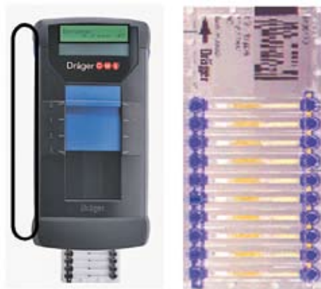
CMS – a digitális kijelzős műszer és a chip
