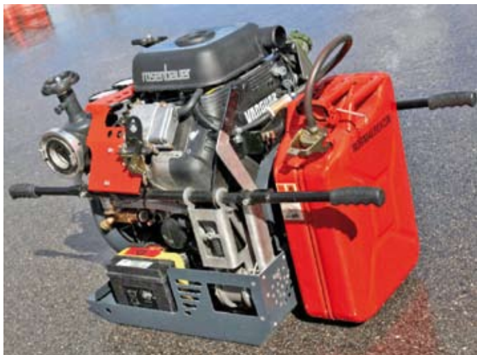
Az üzemanyagtartály működés közben is cserélhető
