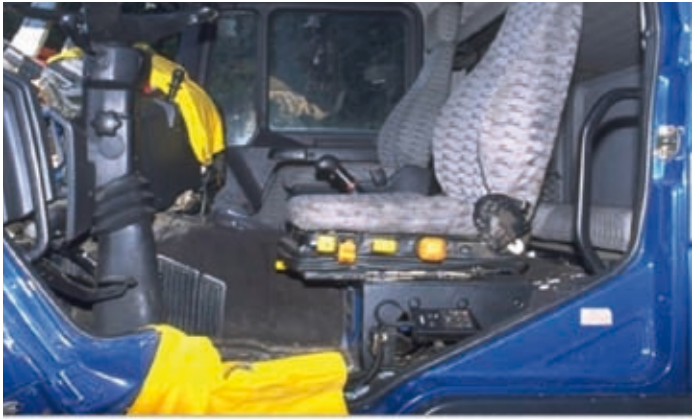
A vágott részek takarása a sérülések elkerülése érdekében
