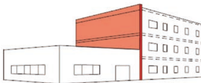
9. ábra. Magasabb épületrész csatlakozása
