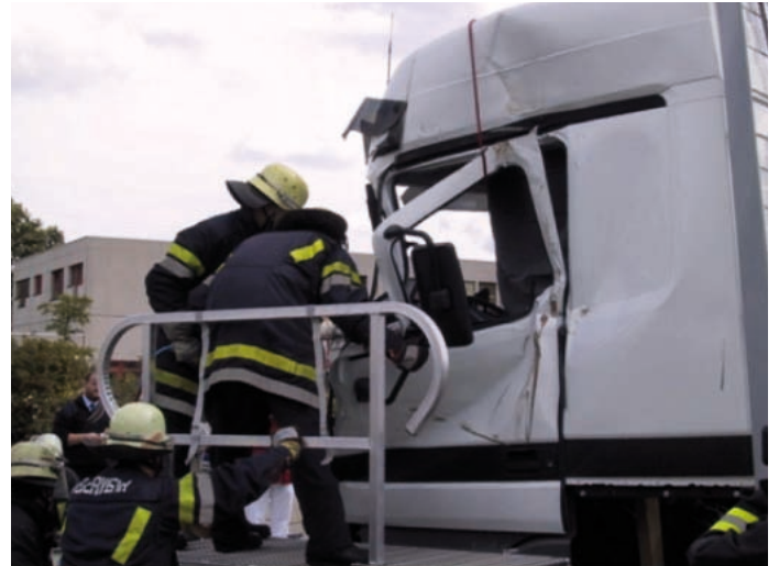
Az ajtó eltávolítása előtt a műanyag részeket eltávolítani, az ajtót kötéllal rögzíteni
