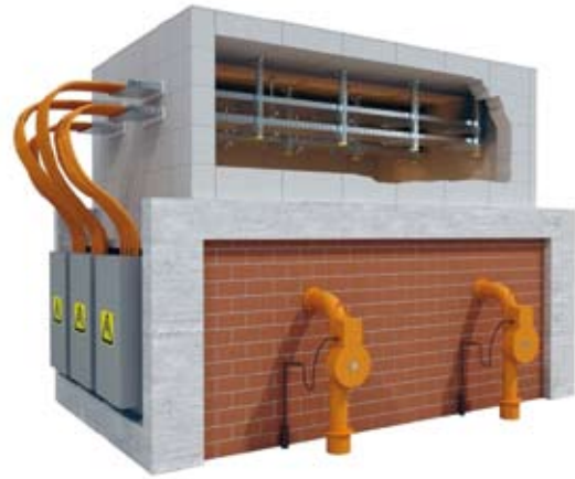
1. ábra. Tűzálló kábelrendszer vizsgálata a DIN 4102-12 szerint
