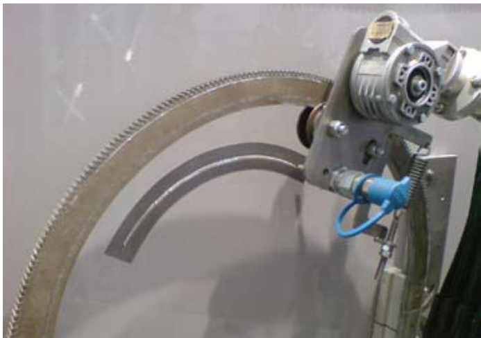
Mentési nyílás vágása acélfelületen
