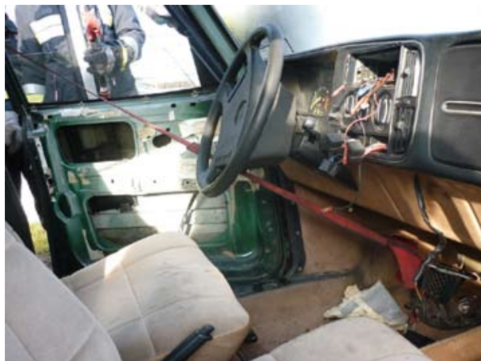
3. kép. A heveder rátekerése az ajtókeretre
