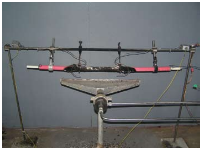
2. ábra. Kábelek szigetelőképesség-megtartásának vizsgálata az IEC 60331 szerint
