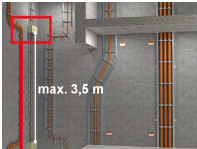
1.a ábra. Tűzálló kábelrendszer felszálló szakaszának hatásos alátámasztása (felül)
