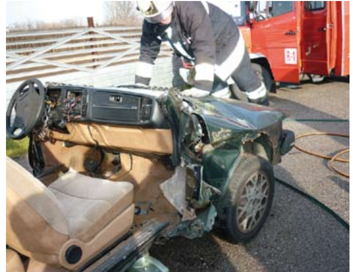
13. kép. A jármű elejének a lehajtása és a megnövekedett lábtér
