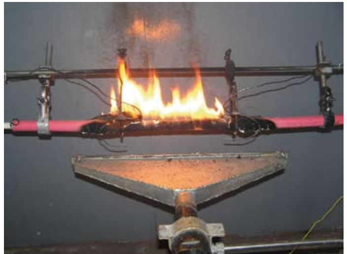
1. ábra. Tűzálló kábelrendszer vizsgálata a DIN 4102-12 szerint
