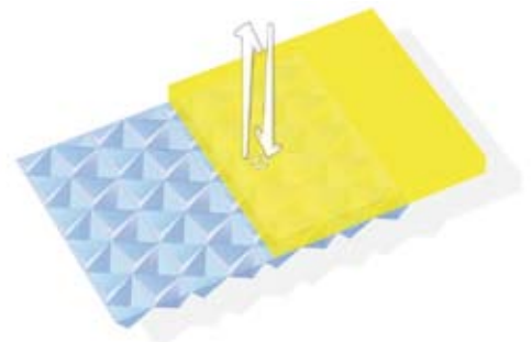
A sárga színnel jelölt védőréteg biztosítja a fényvisszaverő prizma külső környezeti hatásoktól való védelmét
