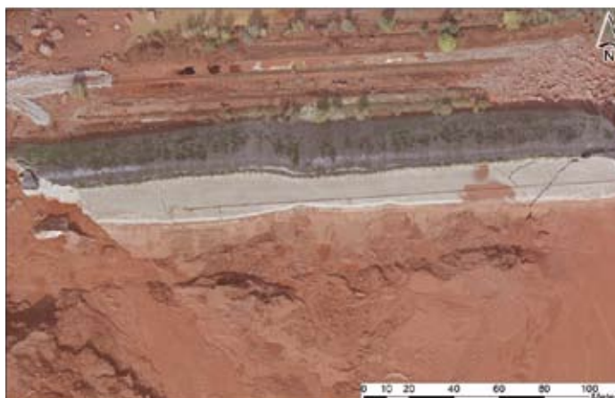
A tározó északi falán három törés látható
