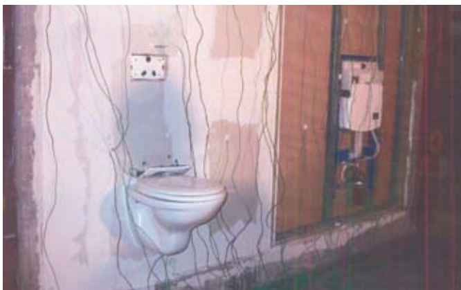
4. kép. WC-t és WC tartályt tartalmazó, tűzállósági vizsgálatra előkészített gipszkarton előtétfal (forrás: ÉMI Nonprofit Kft., a kép nem Magyarországon készült)
