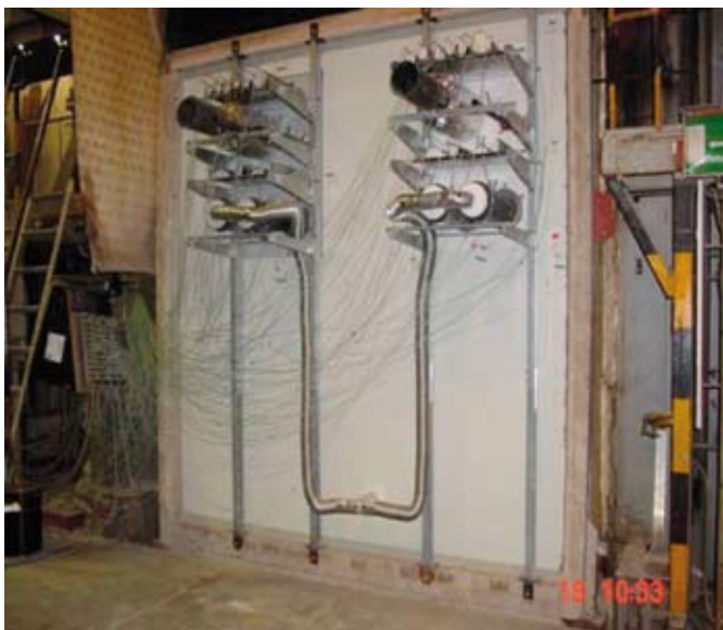
5. kép. Vizsgálatra előkészített szendvicspanel szerkezet, amelybe az áttörések és védelmük beépítésre kerültek (forrás: Trimio; a kép nem Magyarországon készült)
