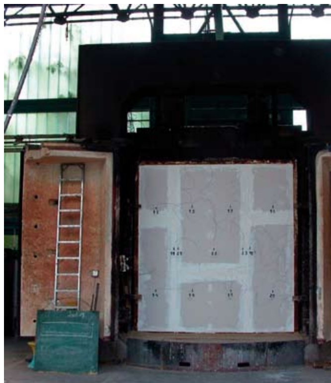
3. kép. Tűzvizsgálatra előkészített gipszkarton fal. Jól látható, hogy a szerkezet semmilyen, a felületfolytonosságot megszakító kiegészítő szerkezetet – pl. WC tartály nyomólappal, elektromos dugalj stb. – nem tartalmaz (fotó: ÉMI Nonprofit Kft)
