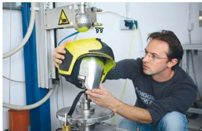
Keménysegvizsgálat a laboratóriumban
