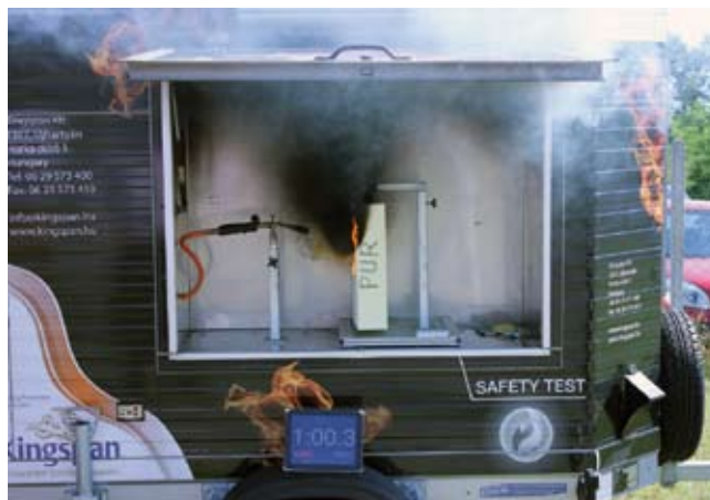
1 perces lánghatásnál már intenzíven lángolt a PUR
