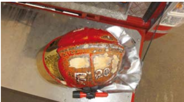
Lángthatás nyomai a reptéri sisakon
