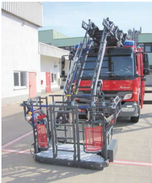
Speciális csuklószerkezettel ellátott kosár
