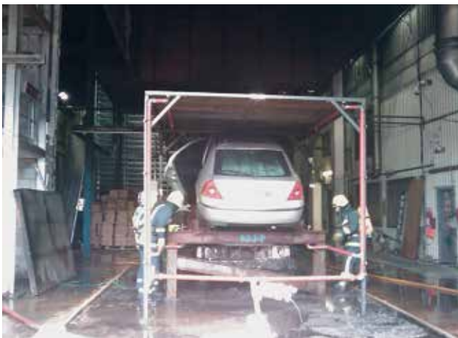
A sprinklerrel védett gépi parkoló, a kísérlet után
