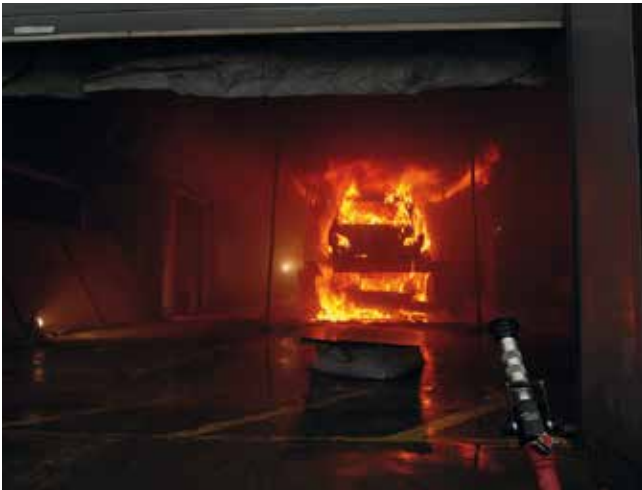
A sprinkler nélküli kísérlet, 10 perc 10 másodperc elteltével
