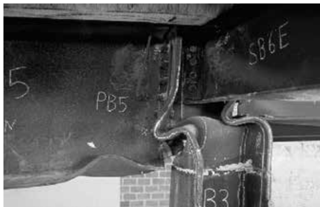
7. ábra. Összenyomódott oszlopfej a tesztet követően
