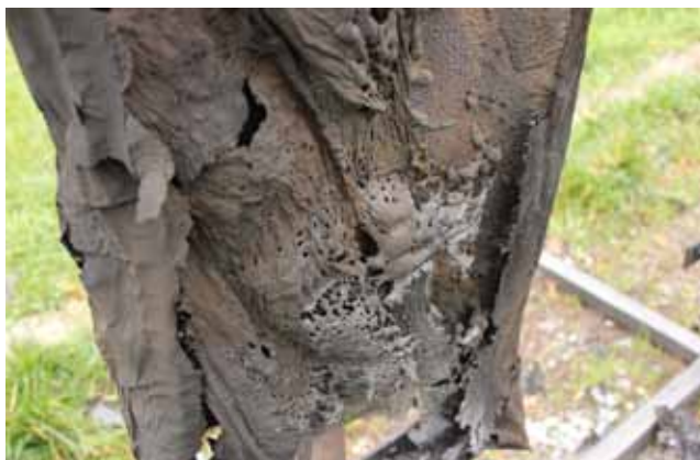
A PUR LAP GYAKORLATILAG „ELOVADT”, SZÉTFOSZLOTT
