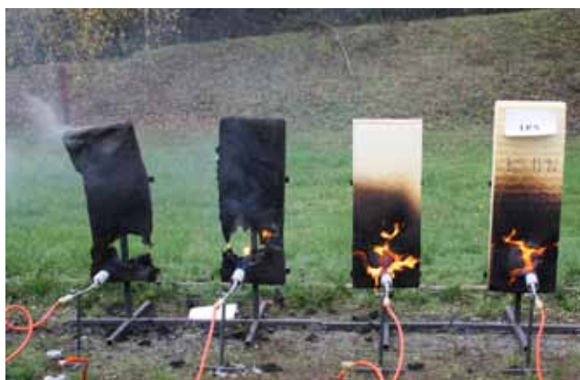
A PIR B2 ÉS AZ IPN DUZZAD, HABOSODIK ÉS A REPEDÉSEK MENTÉN ÉG (2. KÍSÉRLET)
