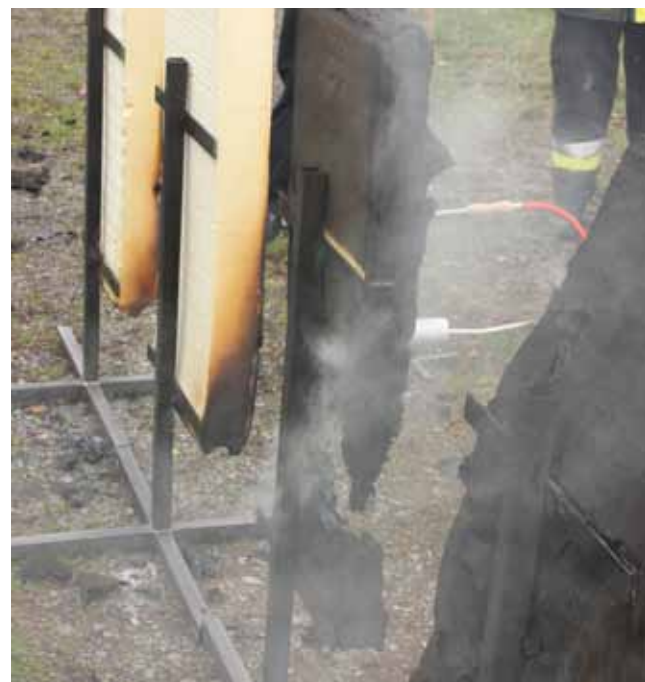
A KÉT PUR MEGSEMMISÜLT, A PIR OLDALA IS SÉRÜLT, AZ IPN OLDALA SÉRTETLEN (2. KÍSÉRLET)
