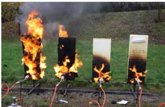
2. PERC: MARKÁNS ELTÉRÉSEK AZ ÉGÉSBEN ÉS A FÜST- FEJLESZTÉSBEN (2. KÍSÉRLET)
