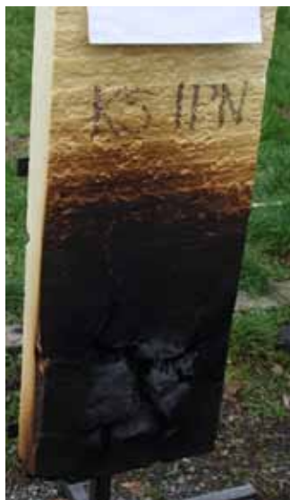
REPEDÉSEK A PIR B2 (BALRA) ÉS AZ IPN (JOBBRA) LAPOKON – A SZENESEDÉS MEGVÉDTE ŐKET (2. K.)
