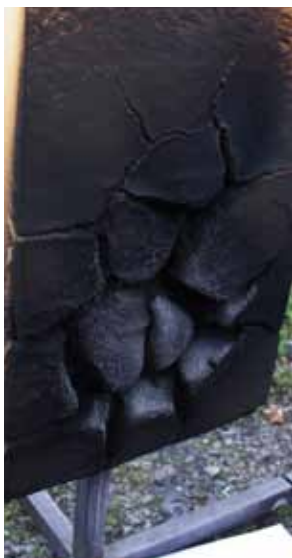
REPEDÉSEK A PIR B2 (BALRA) ÉS AZ IPN (JOBBRA) LAPOKON – A SZENESEDÉS MEGVÉDTE ŐKET (2. K.)
