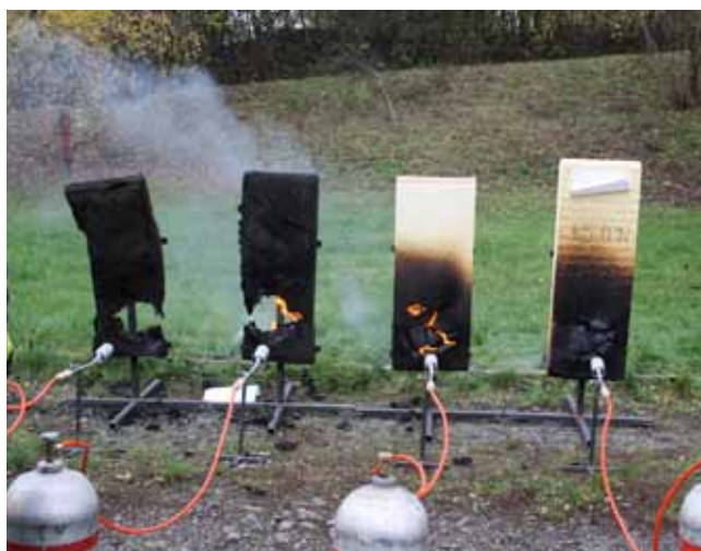
A LÁNG ELVÉTELE UTÁN: A KÉT PUR MEGSEMMISÜLT, A PIR B2 MÉG ÖNÁLLÓAN ÉGETT, AZ IPN AZONNAL KIALUDT (2. KÍSÉRLET)
