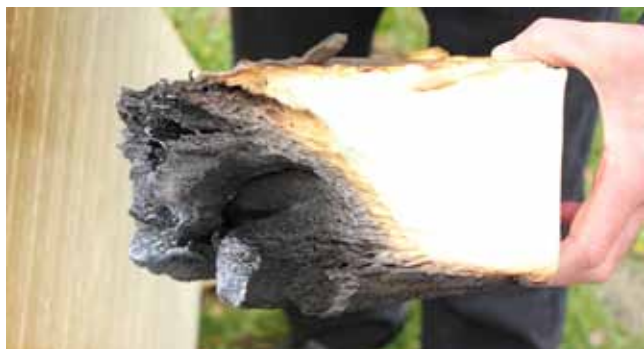
AZ IPN SZERKEZETE: A SZENESEDÉS ÉS A ZSUGORODOTT BARNÁ RÉTEG MEGVÉDTE AZ ANYAGOT (1. KÍSÉRLET)
