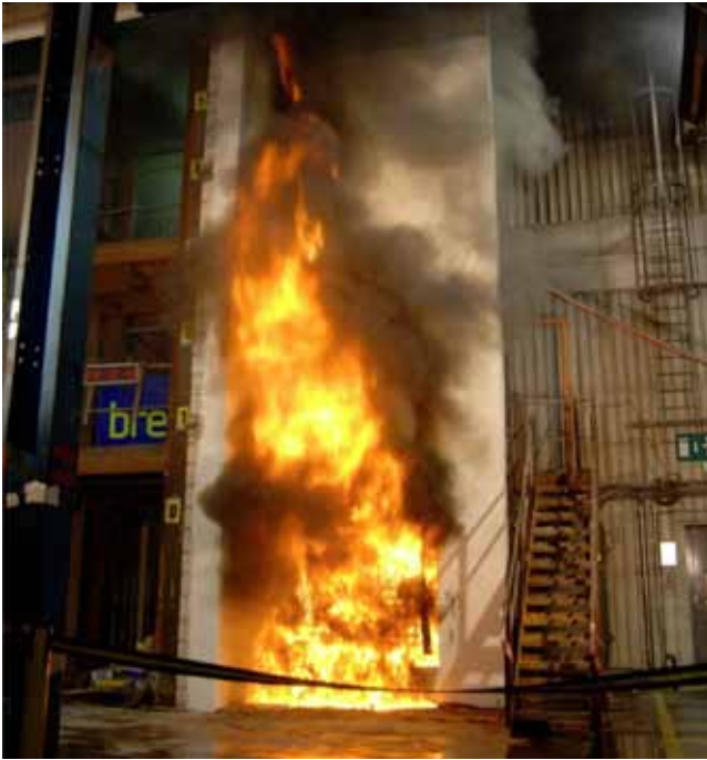
ETICS, EPS HŐSZIGETELŐ RÉTEG TESZT (ISO BS 8414-1) – 200MM-ES KÖZETGYAPOT SÁVOKKAL (3MW HŐFORRÁS)
