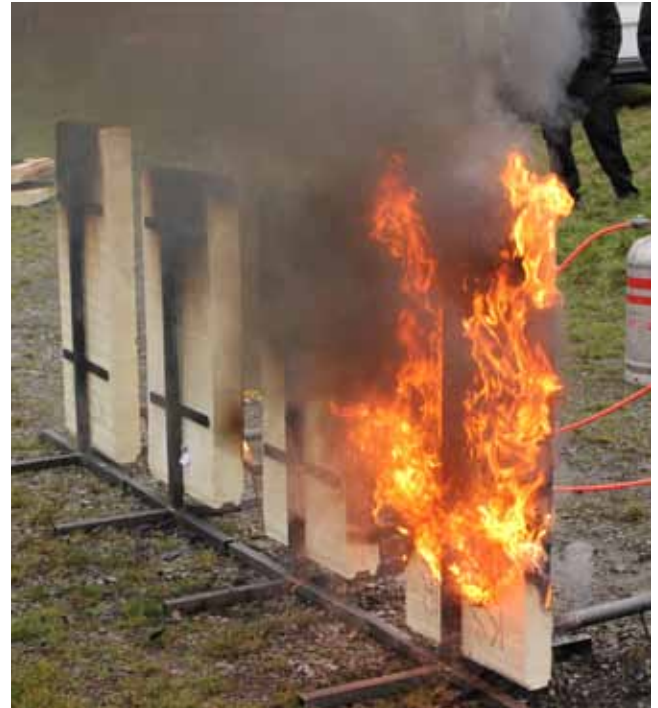
HÁTULNÉZETBEN: LÁNGOL A KÉT PUR (2. KÍSÉRLET)
