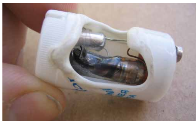
4. ÁBRA: A FÉNYCSŐARMATÚRA GYÚJTÓJA TÚLMELEGEDETT
