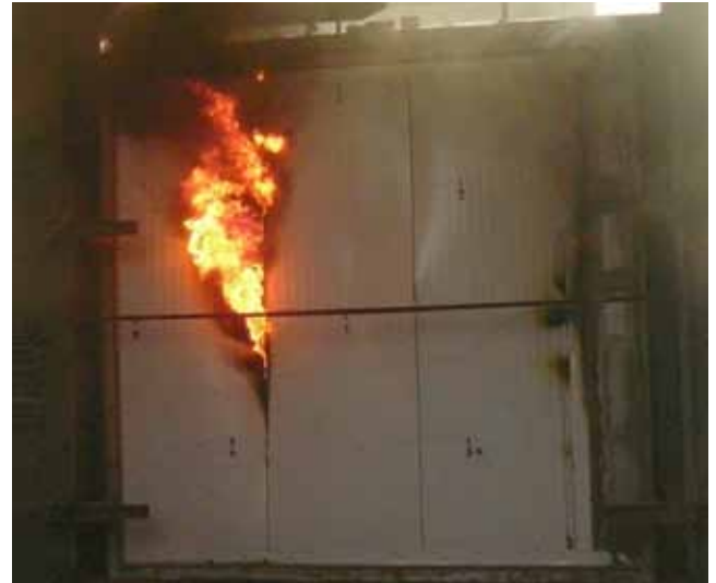
NYÍLÁS NÉLKÜLI SZENDVICSPANEL-FAL TŰZÁLLÓSÁGI VIZSGÁLATA
