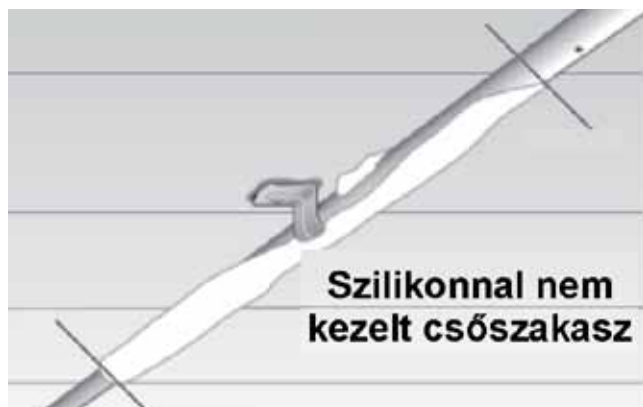
11. ÁBRA: JEGESÉDÉSRE HAJLAMOS CSŐSZAKASZOK SZILIKONOS KEZELÉSE
