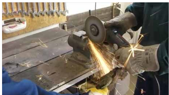
SZENNYEZETT ÜVEGGYAPOT GYÚJTÁSI KÍSÉRLETE SAROKCSISZOLÓVAL
