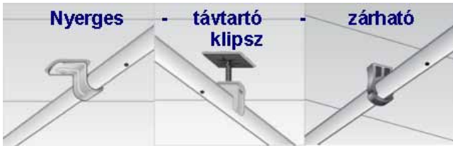
7. ÁBRA: A HOSSZIRÁNYÚ ELMOZDULÁST LEHETŐVÉ TEVŐ BILINCSEK
