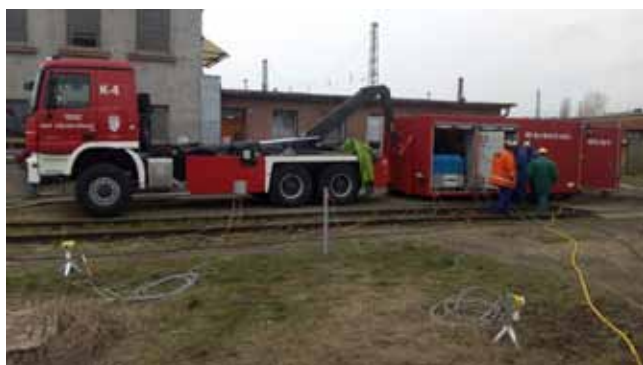
A CSEREFELÉPÍTMÉNYBE ÉPÍTETT VÉSZÁTFEJTŐ BERENDEZÉS
