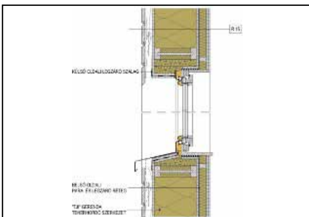
SZERELT, ÁTSZELLŐZTETETT LÉGRÉSES HOMLOKZATBURKOLATTAL ELLÁTOTT FAL ABLAKCSATLAKOZÁSA
