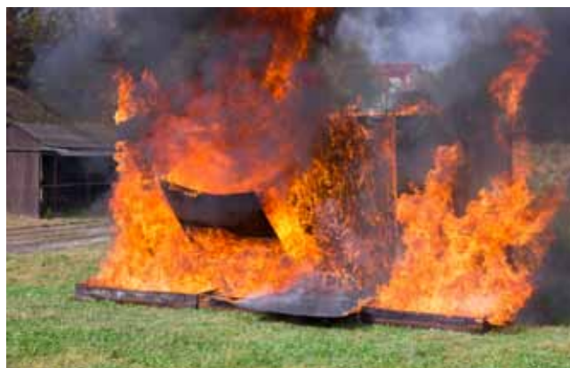
A KŐZETGYAPOT PANEL BURKOLATA LEHULLIK, A PIR-EN ÁTFUT A LÁNG
