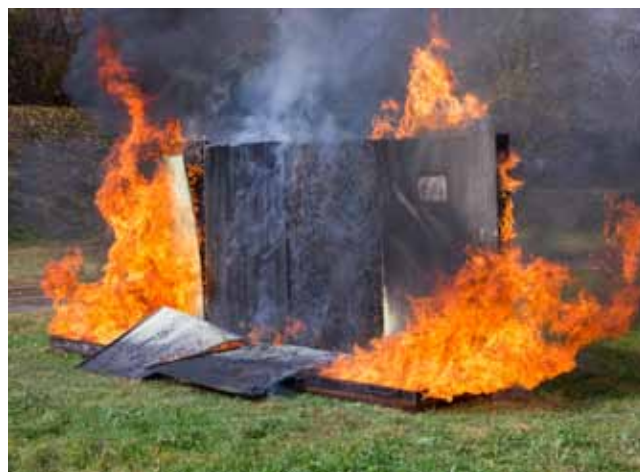
A KÉT KÖZÉPSŐ LEMEZ ALÓL KIÉGŐ GÁZOLAJ MELEGÍTI A KÉT SZÉLSŐT
