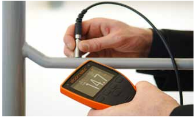
SZÁRAZ RÉTEGVASTAGSÁG MÉRÉSE HELYSZÍNESEN – A HÁROM PARAMÉTER ALAPJÁN MEGHATÁROZOTT
