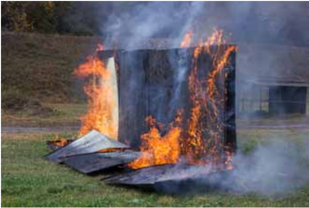
AZ IPN ÉS QUADCORE PANELEN VÉGIGFUT A LÁNG
