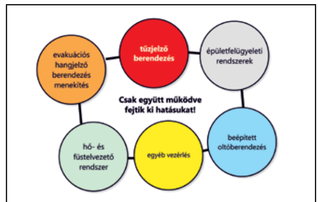
A TŰZVÉDELMI BERENDEZÉSEK RENDSZERE
