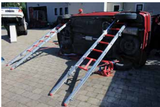
SZEMÉLYGÉPJÁRMŰ RÖGZÍTÉSE LÉTRATAGOKKAL
