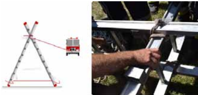
DUGÓLÉTRA ÁLLVÁNYLÉTRÁVÁ ALAKÍTÁSA
