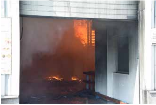
A KAPUK NYITÁSA UTÁN GYORSULT A HŐ ÉS FÜST KIÁRAMLÁSA
