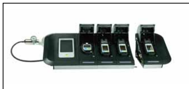
DRÄGER X-DOCK ÁLLOMÁS – AUTOMATA TESZTRE KÉPES
