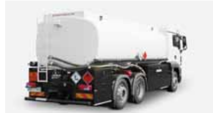
3 tengelyes felépítmény, 19 500 liter, 2,5 tonna
