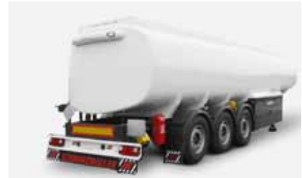
3 tengelyes félpótkocsi (kofferforma); 40 000 liter, 5,5 tonna
